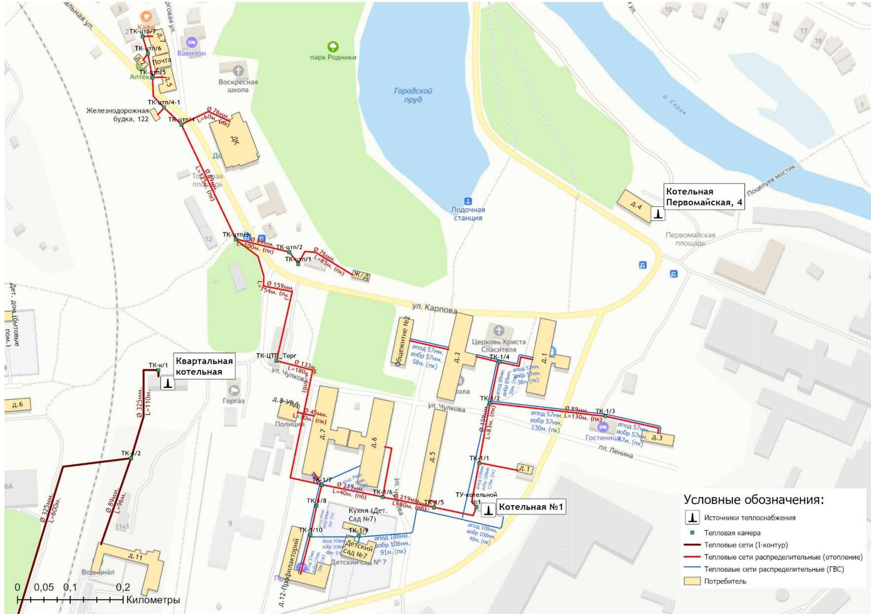
Рисунок 1.3.1.1 - Схема тепловой сети котельной «№1» и котельной Первомайская, 4
